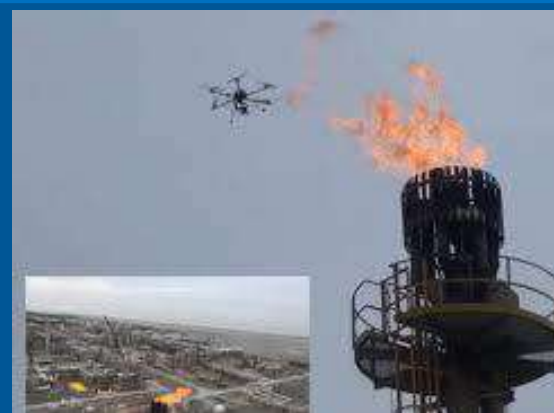
INSPEÇÃO TERMOGRÁFICA REMOTA
